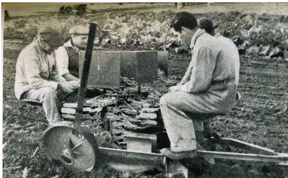
Máquina transplantadora de un surco efectuando un trasplante de hinojo.
